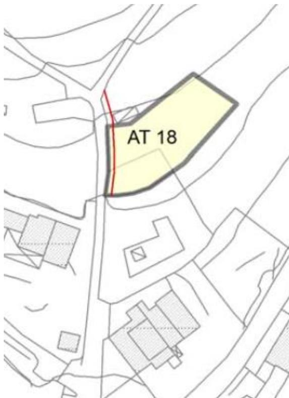
La nuova lottizzazione prevede l'allargamento di via Quassa per il tratto con il confine a ovest e in corrispondenza della biforcazione nord per facilitare la viabilità. E' prevista la realizzazione dei sottoservizi fino alla strada d'accesso privata alla lottizzazione. Al compimento delle opere di urbanizzazione le stesse verranno cedute al patrimonio comunale.
